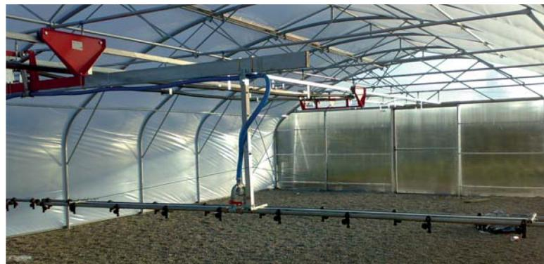
elektronicky v libovolných pozicích dráhy pojedzdu mostu a jejich počet není omezen. Pro každou zónu zvlášť lze změnit rychlosť pojedzdu (rychlejší pojezd snižuje objem závlavy, pomalejší pojezd ji zvyšuje)
